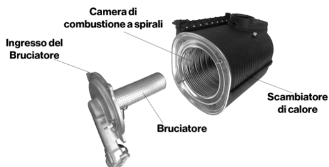
Fig.A: Scambiatore di calore aiM 65 (Isothermic)
